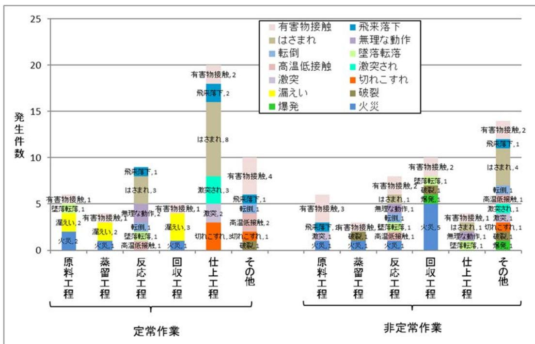
[図Ⅱ-2-5 多結晶シリコン製造工程別事故型発生件数(2005年~2023年)]
