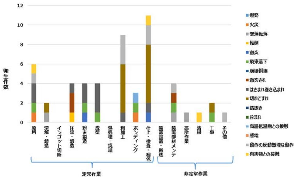
[図 II-8-10 ターゲット製造工程 工程別事故型発生件数(2005年～2023年)]
