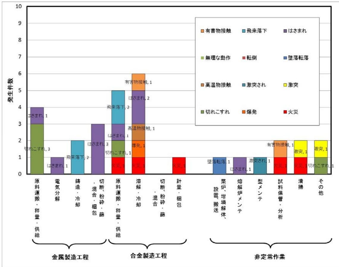
[図 II-4-11 金属・合金製造工程別事故型発生件数(2005年～2023年)]
