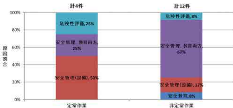
[図Ⅱ-6-12 原因別「保安事故」及び「労働災害」発生割合 (2005年～2024年)]
